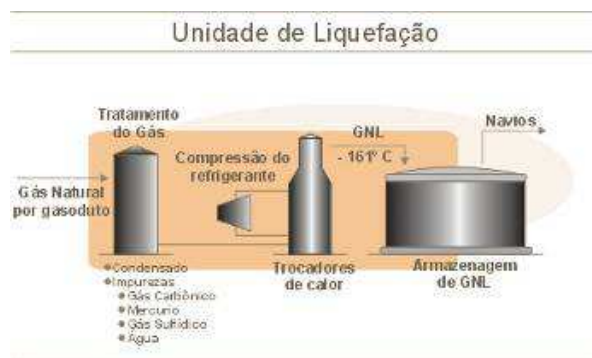
Figura 5 - Processo de liquefação utilizada para produção de GNL e transporte marítimo (Fonte: GasNet)
